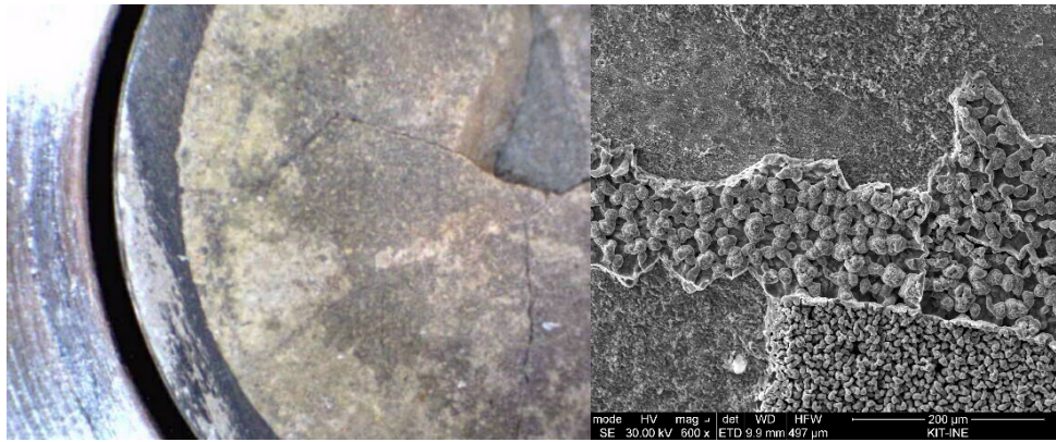
Abbildung 4: Mikroskopaufnahme der Kontaktfläche zwischen dem Hüllrohr und abgebranntem Kernbrennstoff eines DWR-Brennstabsegments mit Abbrand von 50 GWd/t (links). Ausgebildete Wechselwirkungsschicht zwischen Kernbrennstoff und Hüllrohr durch anhaftenden Kernbrennstoff auf der Oberfläche (rechts). (Quelle: E. Gonzalez Robles, M. Herm, T. König, KIT-INE)
