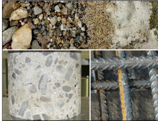
Abbildung 5: Betonausgangsstoffe (oben), Bohrkern (links unten), Bewehrungsstäbe (rechts unten) (Quelle: iBMB, TU Braunschweig)
